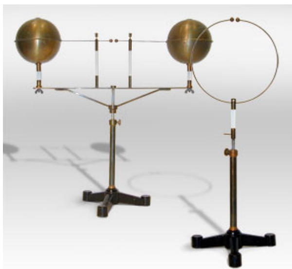
Primeiro aparelho de ondas electromagnéticas construído por Rodolph Hertz.
